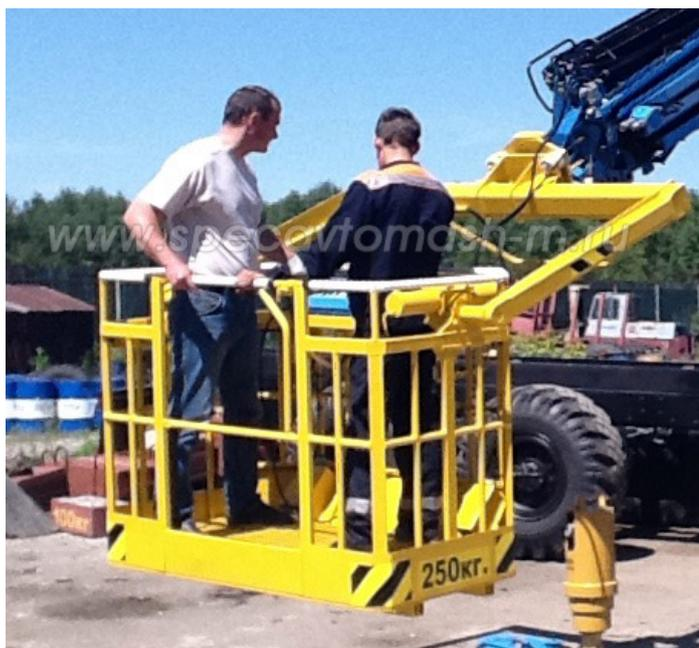
Люлька оборудована гравитационным механизмом горизонтирования люльки и устройством
