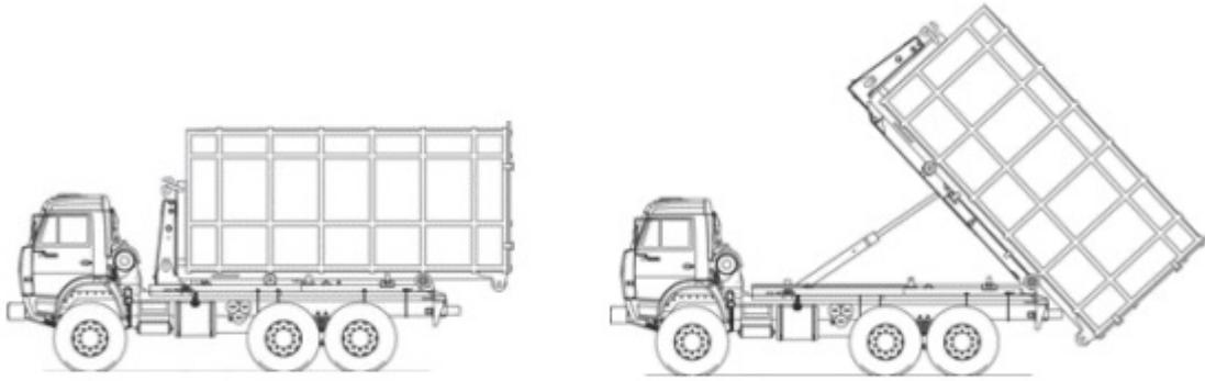
Режим снятия/установки бункера
