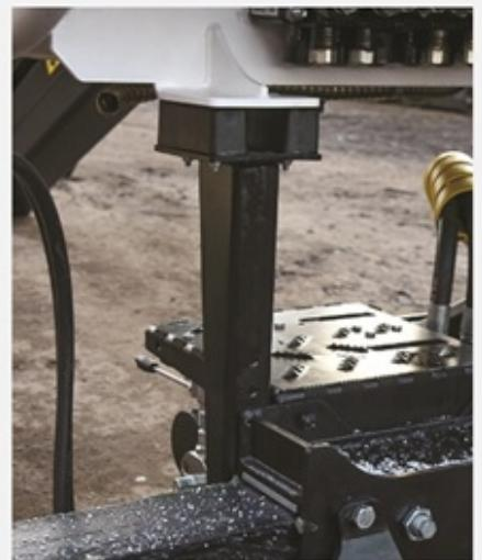
Специальное крепление для транспортировки обеспечивает надежную фиксацию даже при плохих дорожных условиях.
