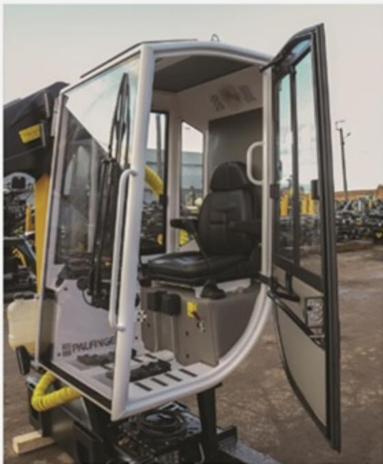
При проектировании учтен 20-летний опыт производства кабин PALFINGER. Каркас кабины, остекление и электрооборудование изготовлены в Европе. Конструкция выполнена из высокопрочных стальных профилей, что гарантирует прочность и долговечность оборудования.
