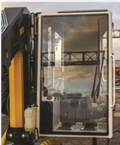
Автономный дизельный обогреватель с вентилятором направленного действия обеспечивает обдув стекла и защищает его от запотевания.
