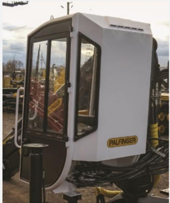
Кабина отличается отменным обзором благодаря широким окнам со всех сторон. Ударопрочное поликарбонатное переднее стекло на всю высоту кабины с антиабразивным покрытием LEXAN может использоваться без металлической решетки. Обзорность во время осадков сохраняется благодаря механическому стеклоочистителю и стеклоомывателю.
