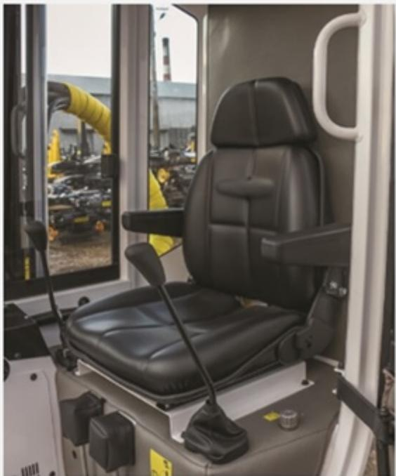
Управление манипулятором осуществляется из кабины с помощью эргономически правильно расположенных рычагов и педалей. Кресло оператора класса Люкс – удобные подлокотники, спинка имеет регулировку по высоте, а сиденье регулируется в горизонтальной плоскости.
